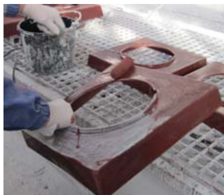
VÝROBA KRYCÍ HLAVY KOMÍNA METODOU RUČNÍHO LAMINOVÁNÍ
