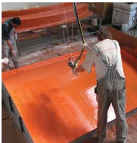
VÝROBA DÍLCE KOMÍNA METODOU STŘÍKÁNÍ
