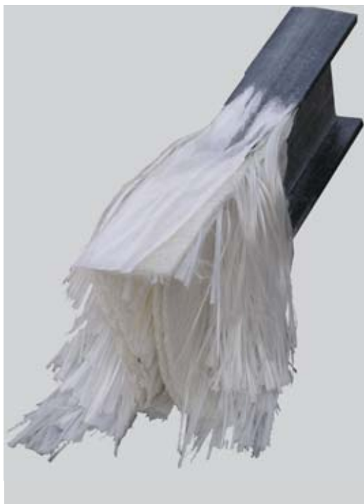
VYZTUŽENÍ PROFILU SKLENĚNÝMI VLÁKNY
