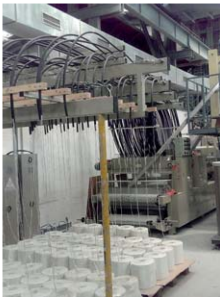
VÝROBA SMC – ZAVÁDĚNÍ SKELNÝCH VLÁKEN
