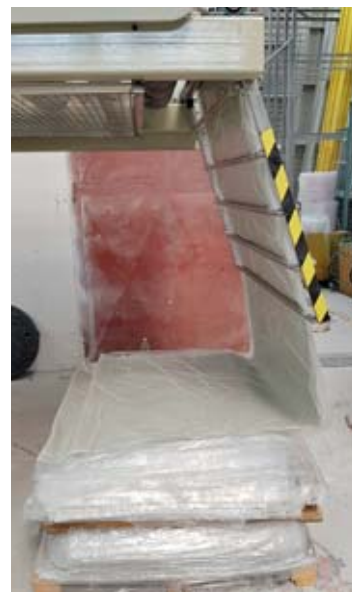
VÝROBA SMC – VÝROBNÝ POLOTOVAR – PREPREG VE DVOJICI FOLIÍ
