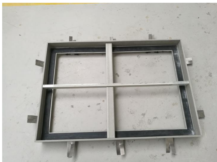
Rozepření rámu proti prohnutí stěn
